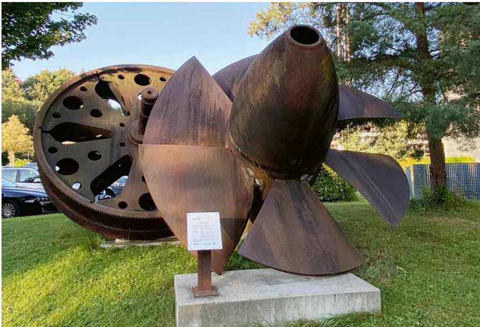
Der erste Blick der Teilnehmer fiel vor der Hochschule auf das Laufrad und Zahnrad der ehemaligen Maschine IV des Kraftwerks Illerstraße in Kempten (Propellerturbine der Fa. Voith mit stehender Welle, Einbau 1925, Ausbau 1982)
