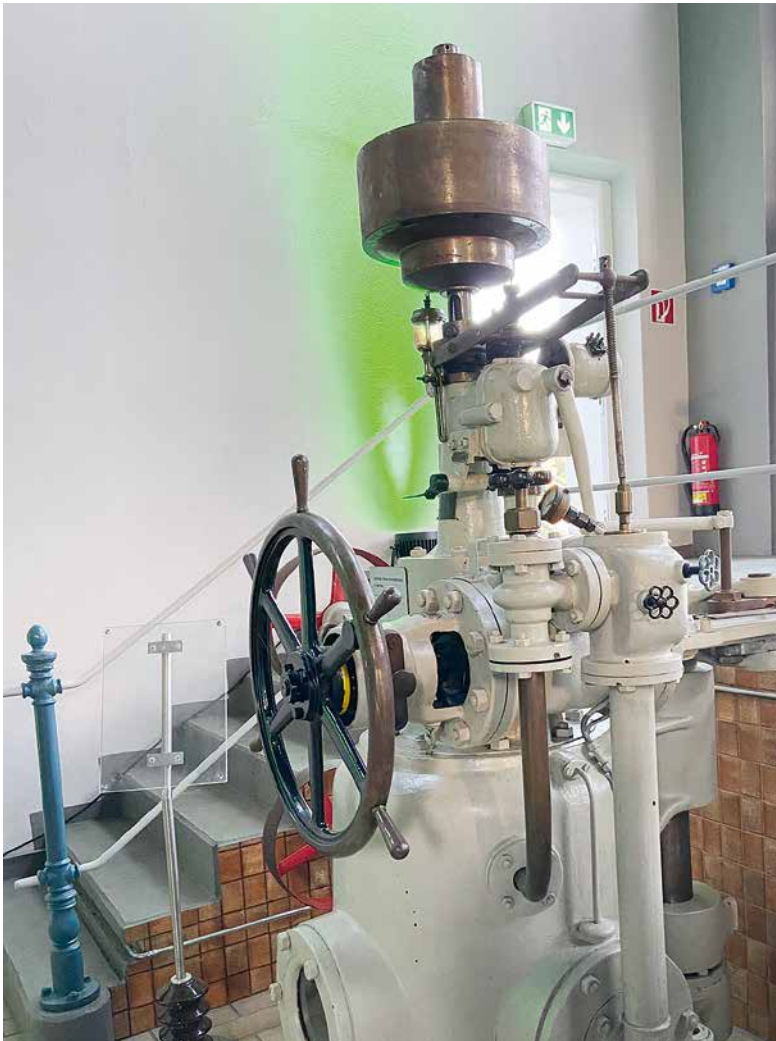
Der Turbinenregler ist ein Sammlerstück und nicht mehr im Betrieb.
